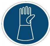
Das Handschuhmaterial muss undurchlässig und beständig gegen das Produkt /den Stoff/ die Zubereitung sein. Die Auswahl des Handschuhmaterials muss unter Beachtung der Durchbruchzeiten, Permeationsraten und der Degradation erfolgen.
